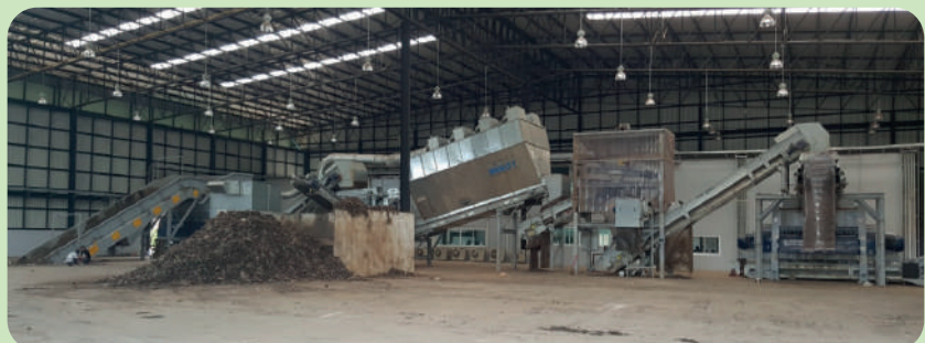
โรงงานคัดแยกและย่อยขยะ เพื่อผลิตเชื้อเพลิง RDF ทุ่งสง นครศรีธรรมราช กำลังการผลิต RDF 300 ตัน / วัน
